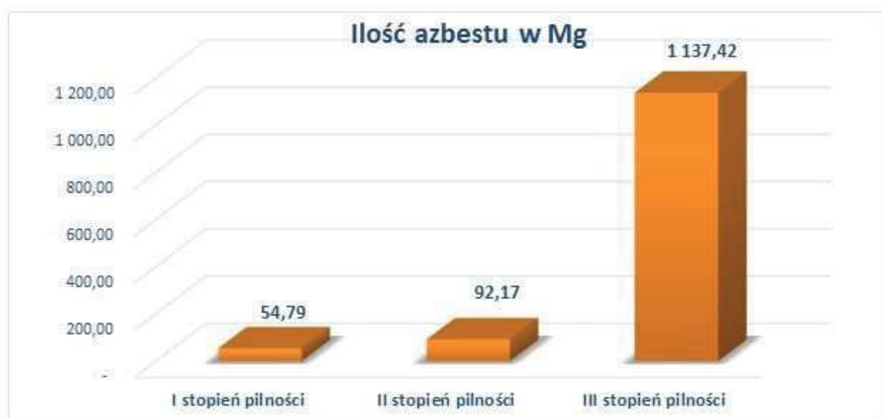
Rysunek 5 Ewidencja wagowa stanu technicznego wyrobów zawierających azbest w obiektach będących własnością osób fizycznych, zlokalizowanych na terenie Gminy Sitkówka-Nowiny
