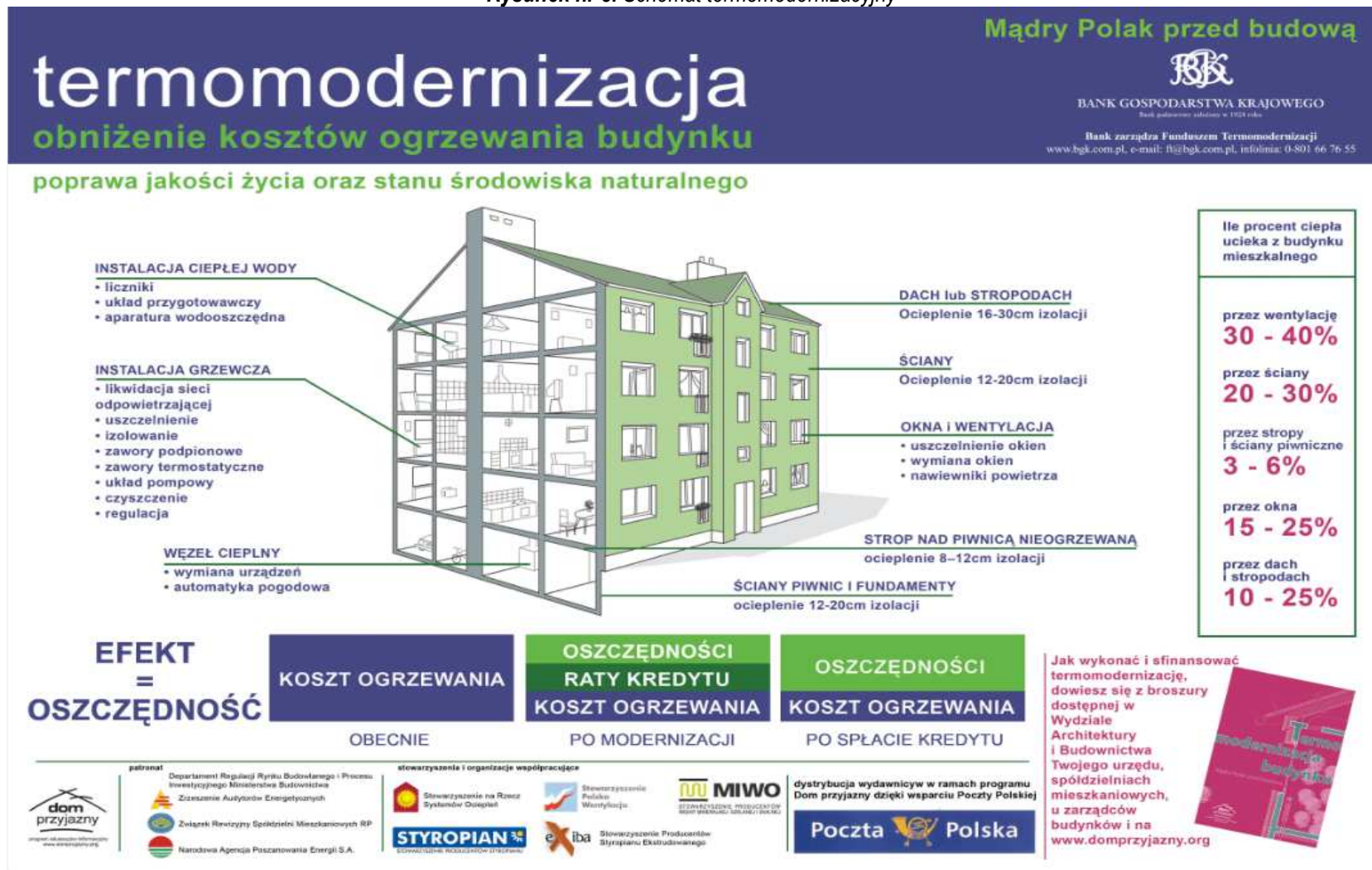
Rysunek nr 8. Schemat termomodernizacyjny
