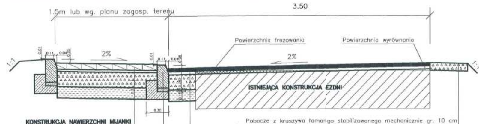
KONSTRUKCJA NAWIERZCHNI W1-W7 Z MIJANKĄ DLA SAM. OSOBOWYCH
