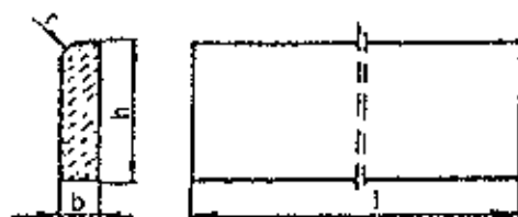
Rysunek 1. Kształt betonowego obrzeża chodnikowego
